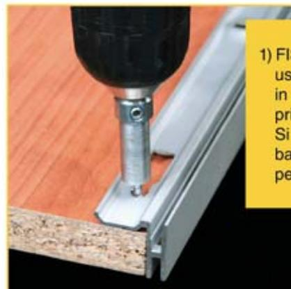
**1) FISSAGGIO DELLE VITI DIETRO AL PANNELLO:** usando il profilo come dima, posizionare le viti in battuta all'asola e avvitare. Fermare la corsa prima di bloccare il profilo. Si consiglia l'uso dell'inserto a regolazione di battuta **NBA.TULL.ZIN** montato sull'avvitatore per velocizzare questa fase di assemblaggio.
