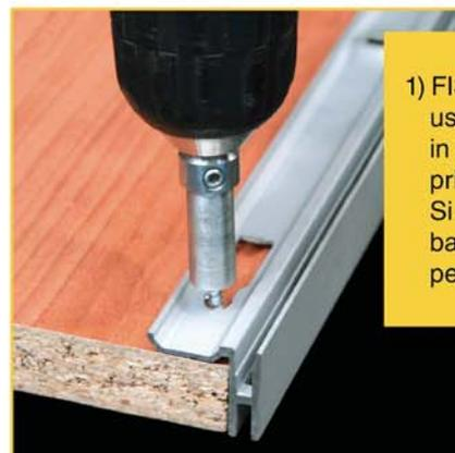
1) FISSAGGIO DELLE VITI DIETRO AL PANNELLO: usando il profilo come dima, posizionare le viti in battuta all'asola e avvitare. Fermare la corsa prima di bloccare il profilo. Si consiglia l'uso dell'insero a regolazione di battuta **NBA.TULL.ZIN** montato sull'avvitatore per velocizzare questa fase di assemblaggio.
