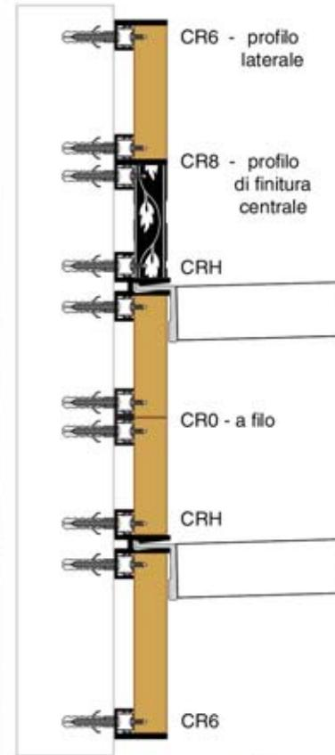
Montaggio di **FMH** su **sistema NB**
