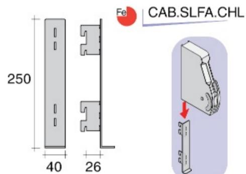
Supporto LIFT singolo per cremagliera singola con distanziatura per abbinamento con CAB.SL02.NAT
