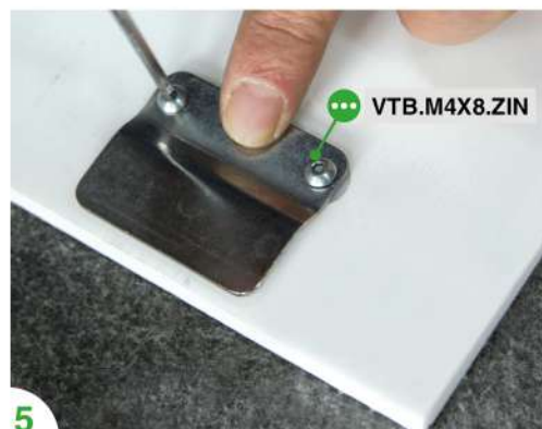
5 5. Avvitare la piastra PST.FMH1.ZIN agli inserti utilizzando le viti VTB.M4X8.ZIN Screw the PST.FMH1.ZIN plate into the inserts with VTB.M4X8.ZIN screws
