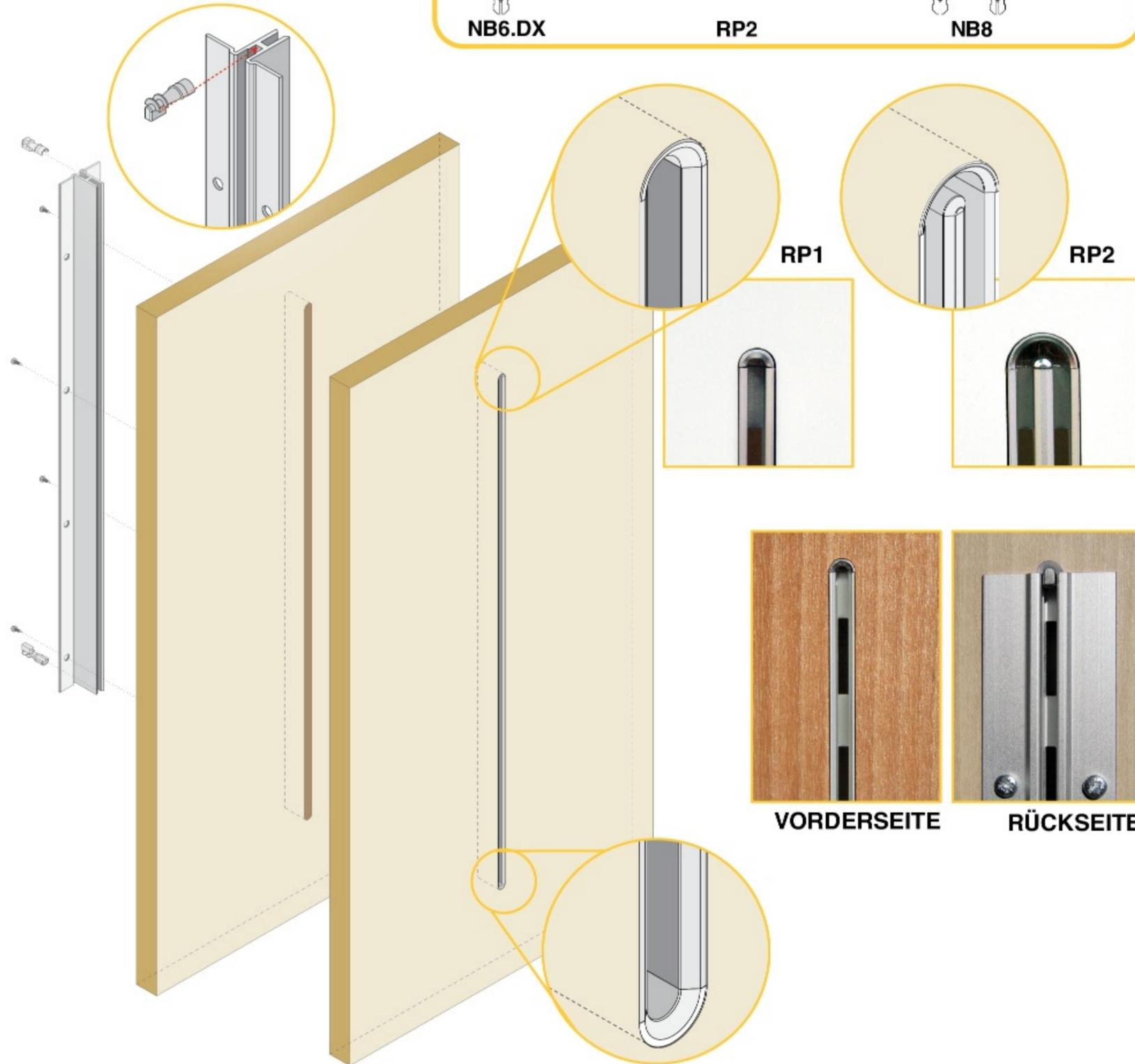
Spiegel Aufstellsystem: Schlitzschiene RP2 mit Profile NB6.SX - NB8 - NB6.DX
