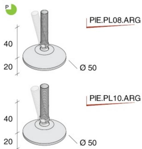
Piedino in alluminio con foro passante per fissaggio a muro - M8 e M10
