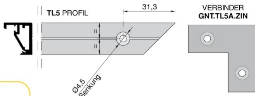
2) Selbstschneidende Gewindeschrauben werden durch Furche im Profil geführt
