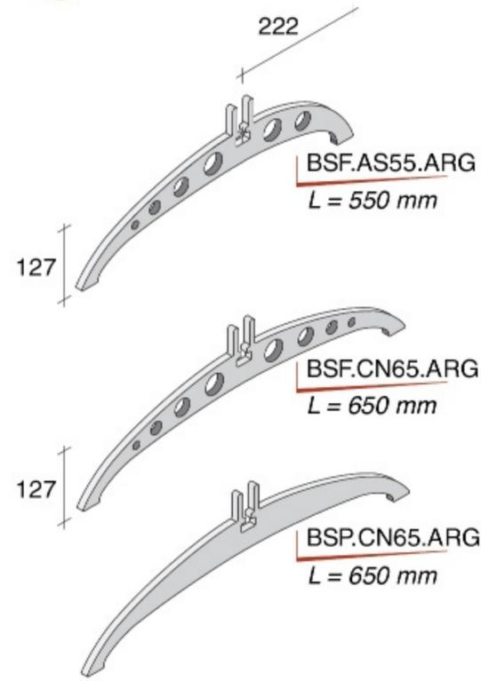
Stützplatte für Abdeckprofile
